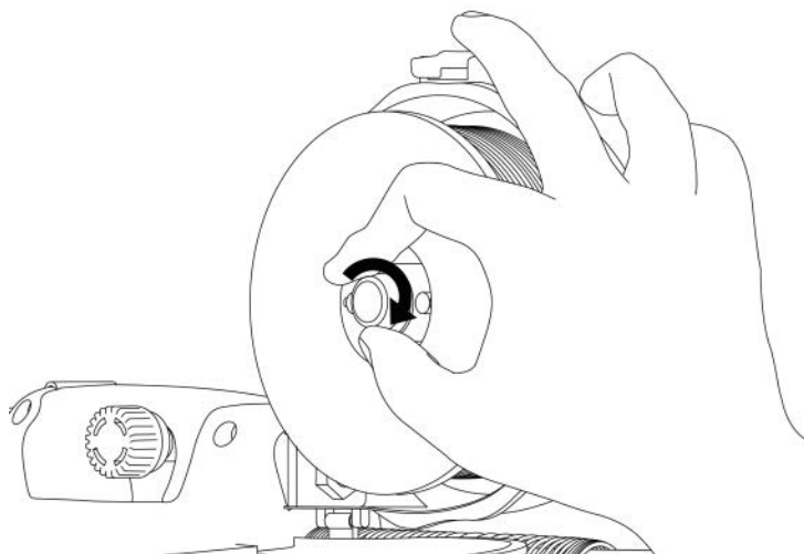
Рис. 7.6. Фиксация катушки с проволокой.
