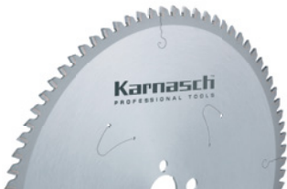
Пластик, алюминий, оконные профили · Отрицательный угол заточки, тонкий пропил Артикул 11.1120, Ø120–550 мм
