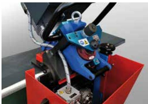
**I STRUTTURA** Struttura in acciaio e fusione di alluminio. Piastra di appoggio temprata con rulli di scorrimento. Trascinamento motorizzato con due ruote in poliuretano (90 shore). Carrello di supporto regolabile in altezza e completo di protezione e cassetto raccogli trucioli completo di ruote girevoli con freno. Possibilità di lavorare con carrello sollevato in presenza di pavimentazione irregolare. Possibile lavorare anche senza il carrello di supporto.
